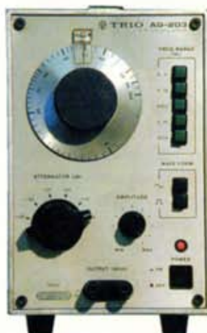
Trio AG-203 - Oscillatore audio 10 Hz - 1 MHz, uscita sinusoide e quadra, livello da 10 mV a 3,5V RMS su 600 Ohm. Distorsione <0,1% a centro banda, ingresso esterno per sincronizzazione. £ 200.000
