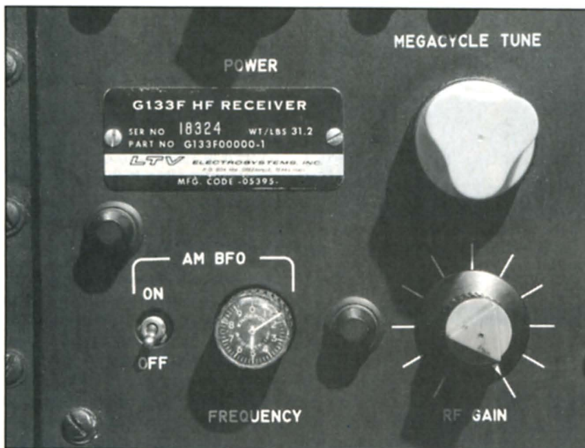
Fig. 1 bis - dettaglio del pannello frontale "AM BFO" e targhetta identificativa
