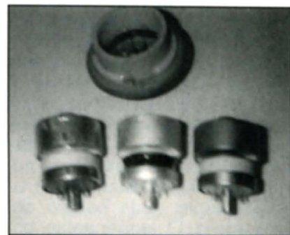
Da sinistra le 3 valvole summenzionate: la cecoslovacca, la 4X-150 e la 4CX-250B. Sopra lo zoccolo con relativo cammino.
