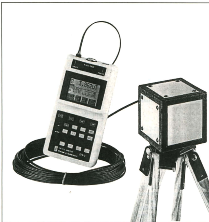
Fig. 2 - L'analizzatore EFA-3 con la sua sonda per il campo elettrico
