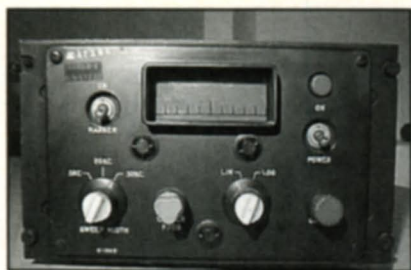
Fig. 7 - Foto del frontale del G186B SPECTRUM DISPLAY UNIT
