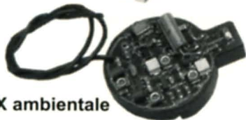
Il VFO, completo di demoltiplica, ma privo di coibentazione, pronto per il montaggio.
