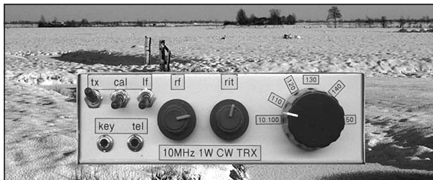
Fig. 3 - L'RTX per i 10 MHz in CW, di PA2OHH
