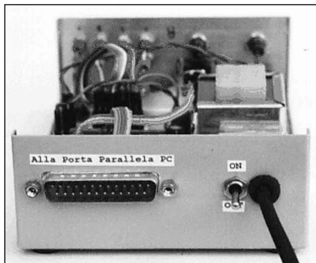
Foto 4 - Retro del contenitore con il connettore della la porta parallela a 25 pin e l'interruttore On-Off
