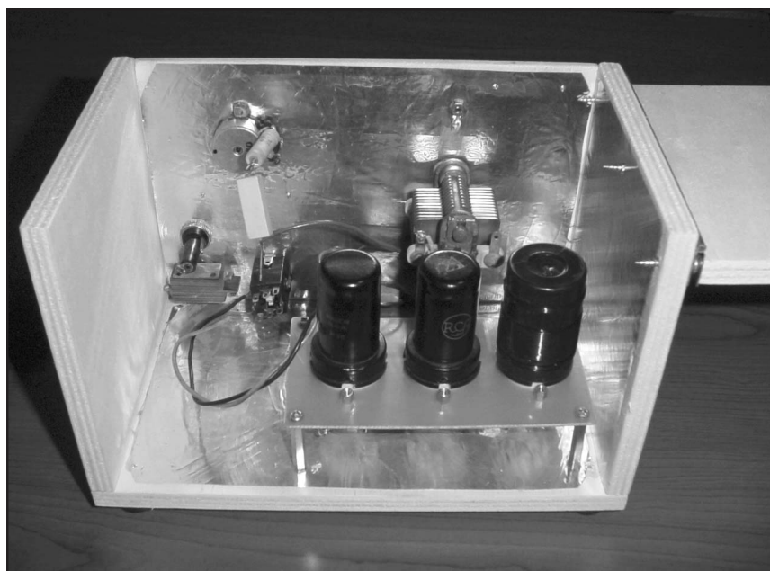
Partendo da Sinistra verso destra si notano le due 6C5 ed il supporto delle bobine.
