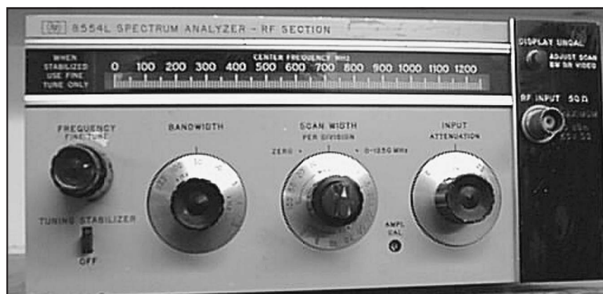
Fig. 5 - Di HP8554 rf section ne esiste anche una versione tipo "L" anziché "B" considerata "OLD VERSION" che oltre a differenziarsi nel colore del pannello, come in tutte le versioni "OLD" (vecchie), si differenzia per l'assai ben più importante differenza che consiste nel non avere le due uscite sul pannello anteriore "FIRST LO" e "THIRD LO" il che non gli permette il collegamento e l'uso del tracking HP8444B
