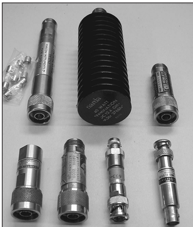
Fig.3a - Alcuni oggetti necessari nelle misure a radiofrequenza e non. Dall'alto a SX si vedono: un fusibile per RF MARCONI con i suoi ricambi, un carico di potenza NARDA40W dalla dc a 12,4 GHz, una transizione 50 \Omega HP11852A 1W@1GHz, una terminazione (carico) per segnale 50 \Omega HP908A, un attenuatore da 20 dB HP8491A, atten.di 10 dB, un adattatore d'impedenza HP11048C.
