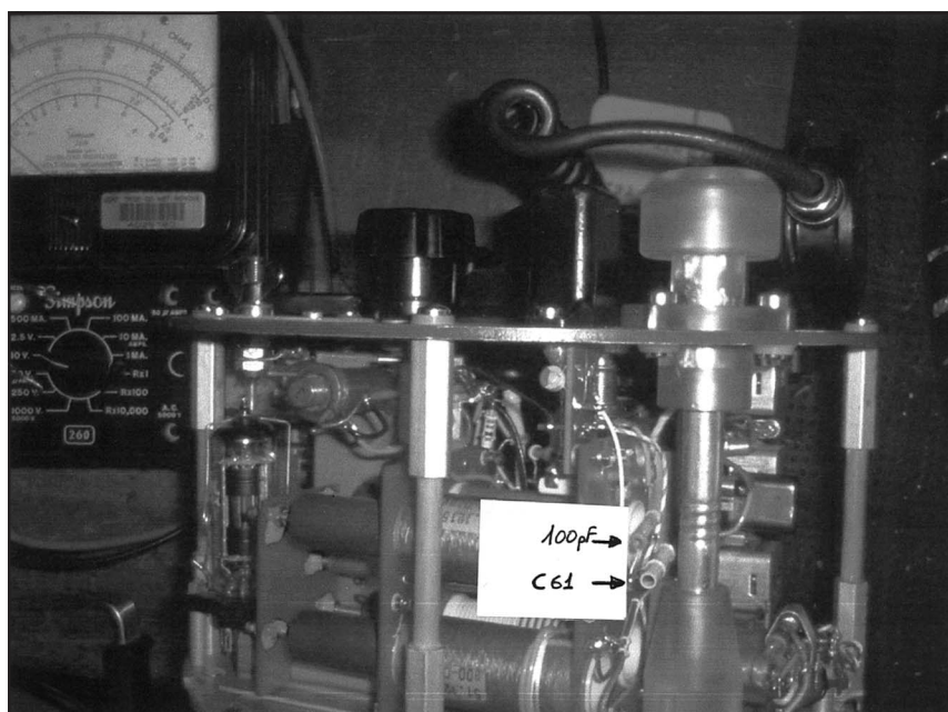
Sintonia variometro d'antenna. Il condensatore da 100 pF in parallelo al C61
