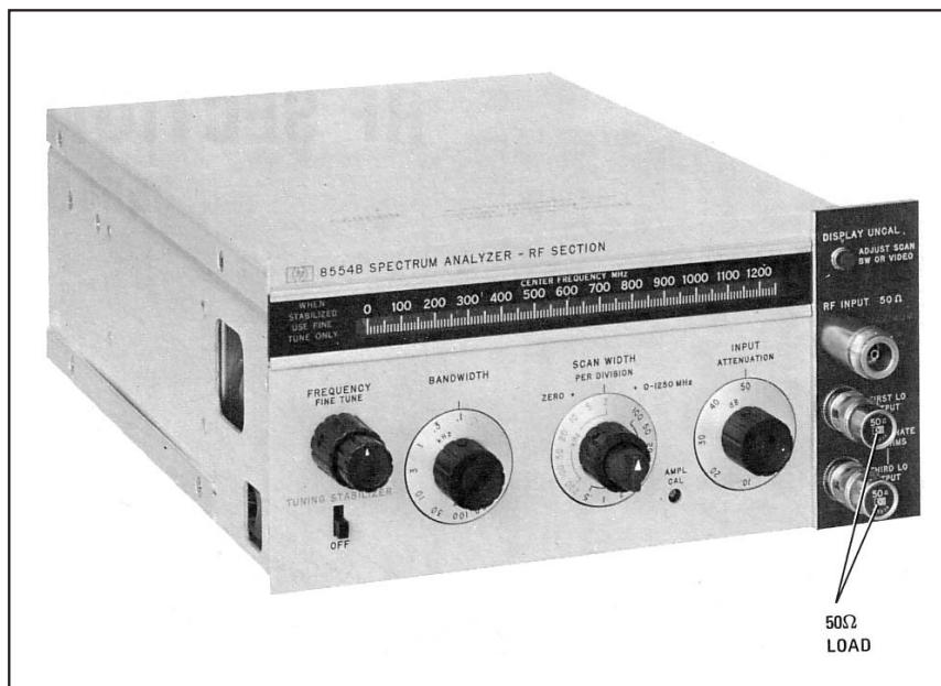
Fig. 1 - Cassetto analizzatore HP8554B, si possono notare i due "tappi" da 50Ω inseriti a chiusura delle uscite dei due oscillatori First e Third LO
