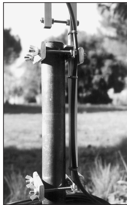
Foto 3 - Dettaglio del fissaggio al palo di sostegno.
