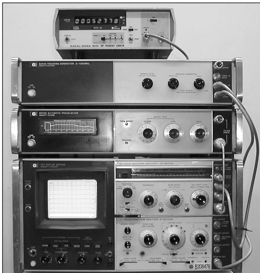
Fig. 4 - Il sistema HP141 con HP8555A e IF HP8552B + HP8445A + HP8444A - Si notino i collegamenti tra i vari apparati; il set comprende anche un frequenzimetro (in questo caso non HP) per la misura della frequenza sintonizzabile nella banda 0.01 - 2.05 GHz. Le procedure per l'uso del frequenzimetro saranno spiegate nella prossima puntata
