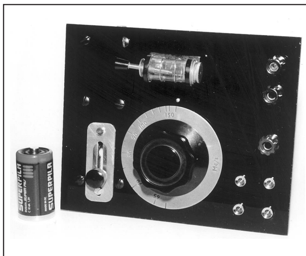
Super galena con detector a cristallo di galena, appunto, notare alla sinistra della manopola di sintonia il comando dell'accoppiamento; la borchietta è quella del prototipo realizzata con PCB doppio rame; in seguito sarà sostituita con una in ottone cromato.
