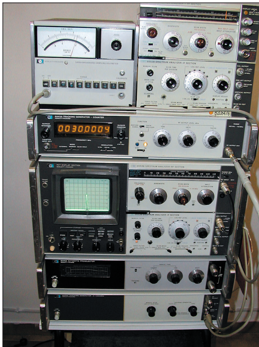
Fig. 1a - Set completo del sistema 141, con inserito il cassetto analizzatore 8553B, i cassettei 8555° con la sua IF sono appoggiati sopra, l'8556° qui non compare, le connessioni anteriori tra i vari accessori (tracking 8444 e preselector 8445) sono state tolte; questo set è approntato a scopo dimostrativo per effettuare la misura assoluta in frequenza nella posizione RESTORE SIGNAL (tracking 8443A); in questo caso il segnale in esame è quello del calibratore. Il voltmetro elettronico Sampler HP 3406A è presente solo per questa dimostrazione.
