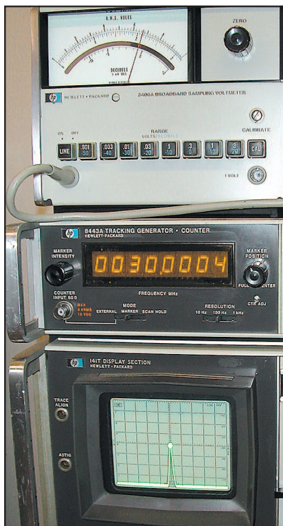
Fig.1b È visibile il particolare dei display del set di fig.1a, in cui si vede il marker sul responso del calibratore (30 MHz @ -30dBm) mentre sul counter del tracking si legge la frequenza esatta e sul voltmetro elettronico collegato all'uscita del tracking si legge il livello del segnale che in questo caso è quello impostato sull'attenuatore del tracking stesso (-39.5 dBm anziché i -30 dBm del calibratore); a riprova di quanto spiegato nel paragrafo sopra, spostando il comando MARKER POSITION al di fuori del responso di segnale (picco), si noterà che le letture del counter e del voltmetro elettronico si sganceranno e non saranno più significative
