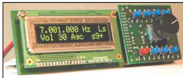
Foto della scheda PIC assemblata (le scritte sul display non si riferiscono a questo utilizzo).
