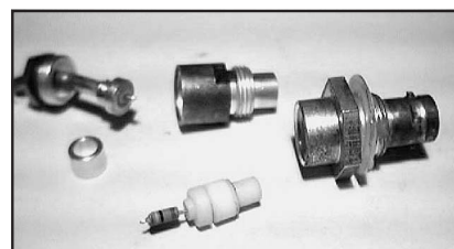
Fig. 8 - Kit di trasformazione da 50 \Omega a 75 \Omega dell'impedenza di ingresso.
