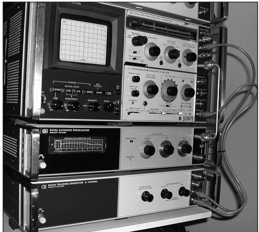
Fig. 2b - Set 141T a 18 GHz completo, qui il Tracking Preselector ed il Tracking Analyzer sono montati sotto si notino le connessioni tra i vari apparecchi.
