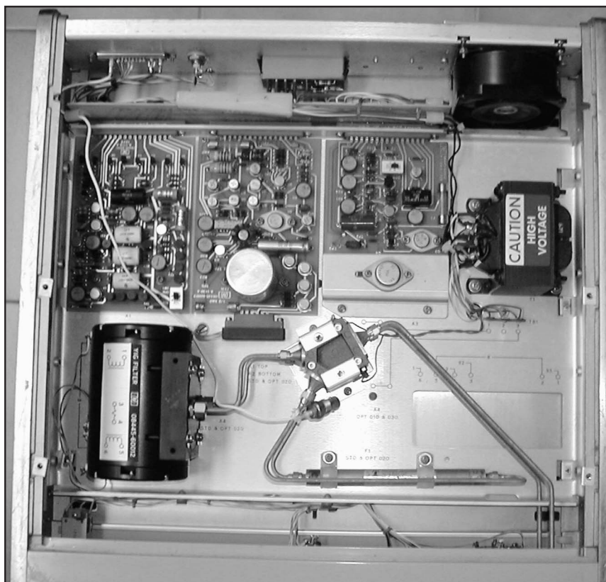
Fig. 5 - Interno di un Tracking Preselector HP8445A opt 020. Si notano da sx in alto i circuiti di regolazione e di alimentazione, sotto da sx il filtro variabile Yig (quello grosso assomigliante ad un motore) poi il commutatore in cavità e più sotto a forma di siluro, il filtro fisso Passa Basso.
