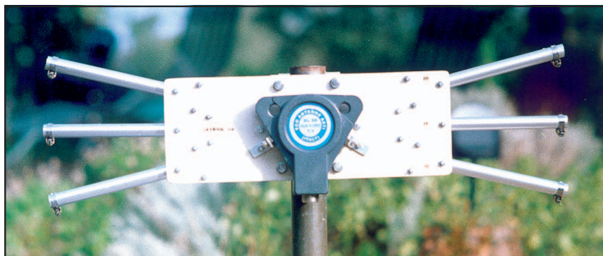
Vista della parte centrale. Sopra lato balun, sotto lato elementi.
