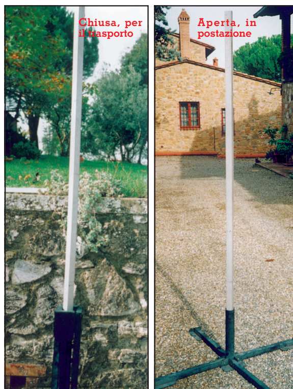
Seconda soluzione: la base da ombrellone. P.S. in tutte le foto c'è solo la prima sezione del palo (circa 2 metri), la seconda viene innestata a incastro come da disegni.
