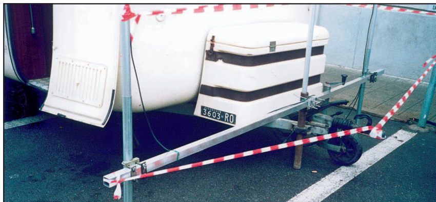
Terza soluzione: l'aggancio al timone della roulotte. Si vede (lato targa) il porta-ruotino aggiunto. Con una barra si montano tre pali, per quattro pali bisogna fare il triangolo.
