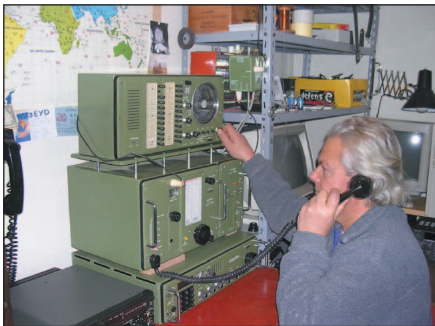
Foto 1 - SAILOR TX type T126 e SAILOR RX type R105 un tipico apparato per uso nautico anni 70.
