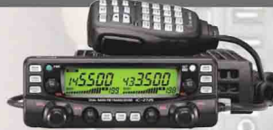
IC-2725E DUAL BAND V/V - U/V - V/U ■ FRONTALE SEPARABILE ■ ROBUSTO ■ CONTROLLI INDIPENDENTI SINTONIA, VOLUME, SQUELCH ■ DISPLAY LCD COLORI SELEZ. ■ 50W IN VHF ■ 9600BPS ■ DTCS/CTCSS ■ 212 MEMORIE
