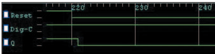
Fig. 6 - C1 è scarico, RESET diventa 0 e pertanto l'uscita Q diventa 0.
