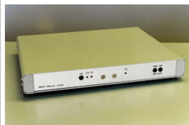
Fig. 10 - Equalizzatore ambientale. Sono previsti 10 moduli dedicati alle varie frequenze f_o indicate nella tabella 1.
