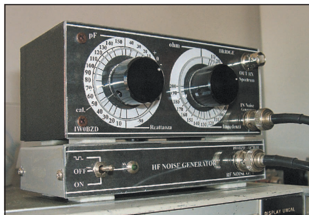
Fig. 3 - Realizzazione del frontale "casalingo" del contenitore di IW0BZD realizzato mediante uso di PC.
