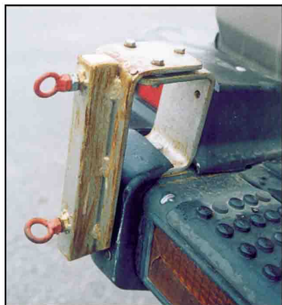
Particolare dell'attacco fisso per l'antenna HF (paraurti posteriore)
