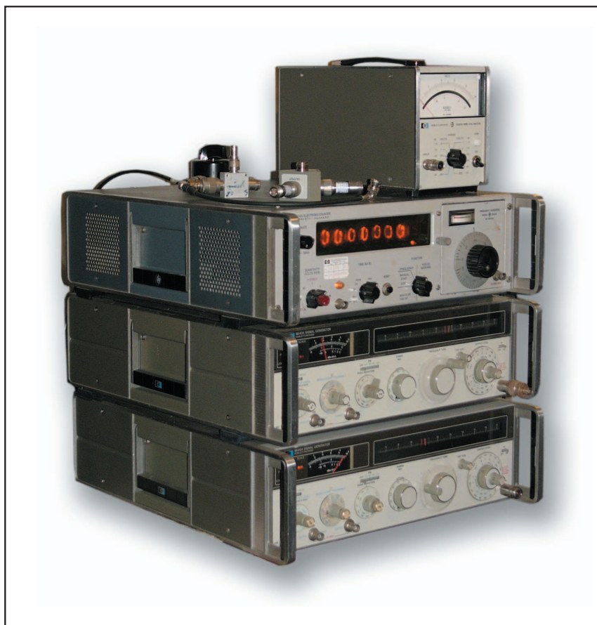
Fig. 8 - Questi semplici strumenti posti su un carrellino costituiscono il mio 'banco per la misura di IP2 e IP3'. Approntatelo anche voi e vedrete come gli dei cominceranno a cadere!!
