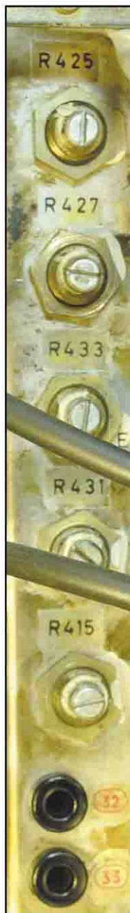
Fig. 7 - I 5 potenziometri per la regolazione dell'AGC ai vari stadi
