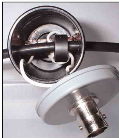
Sistema di accoppiamento a trasformatore secondo G4FON
