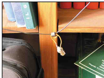
Sistema di accoppiamento a trasformatore con nucleo binoculare secondo I0SKK
