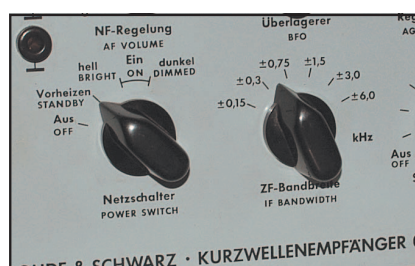
Fig. 14 - Notare l'indice della selettività posizionato fra due valori in quanto solo nella versione D2 la variazione è continua.
