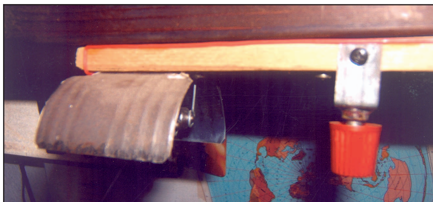
La lampada per il tavolo radio. È a due lampadine a siluro, con i portalampe fatti in filo di ferro. Una simile è sopra il computer, con una sola lampadina (per vedere la tastiera, basta). Entrambe sono montate su una piccola stecca in legno, con lo stesso interruttore a bullone.
