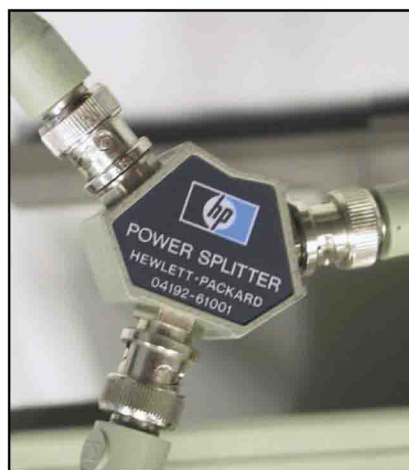
Fig. 23 - Il power splitter.
