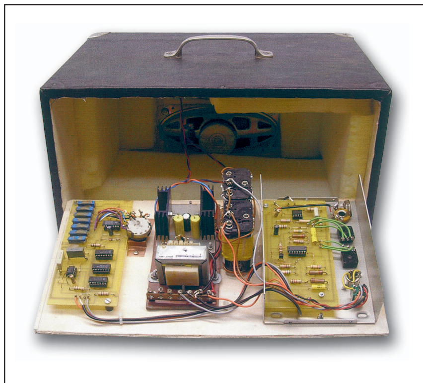
Fig. 2 - Foto interna dell'amplificatore accordatore: a sinistra è visibile il generatore dei toni, al centro lo stadio finale ed a destra la parte schermata, relativa al CAV ed all'ingresso strumento (il coperchio è rimosso). L'interno del mobile è foderato con strisce di gommapiuma per impedire eventuali risonanze.
