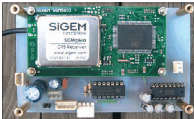
Foto 2 - Immagine dell'interfaccia PIC - Seriale
