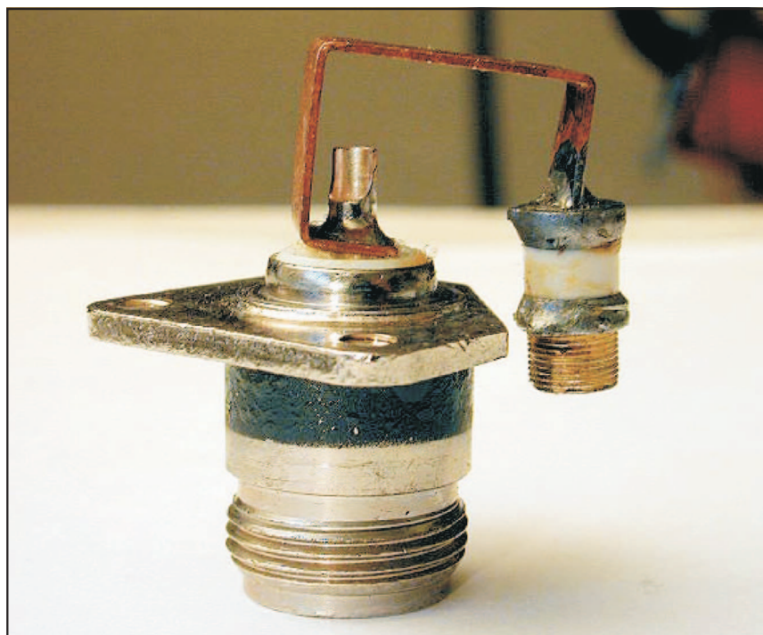
Fig. 2 - Esempio di connettore N con il link induttivo e la capacità variabile in serie.
