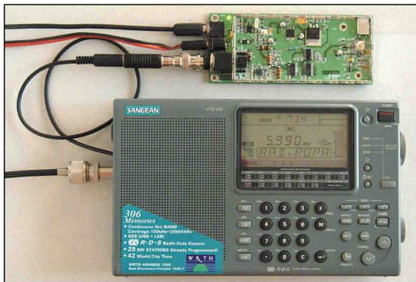
Fig. 4 - Sangean ATS 909 con scheda Elad FDM 45512, pronti a ricevere la DW.
