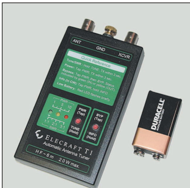
Fig. 9 - Autotuner T1 Elecraft (6 - 160 m) vista esterna
