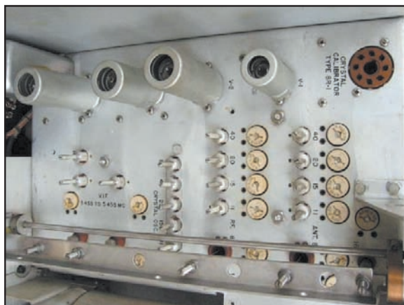
Fig. 7 - Induttori a permeabilità variabile e trimmer di taratura nel "front-end" del ricevitore.
