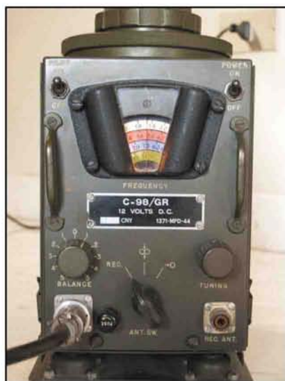
Dettaglio del pannello frontale del Control Box C-98/GR
