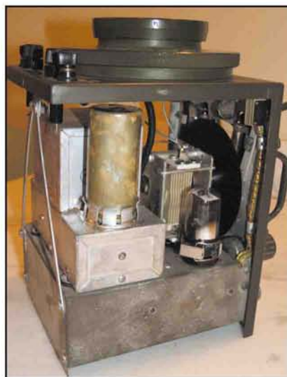
Vista interna lato vibratore e valvola V_1
