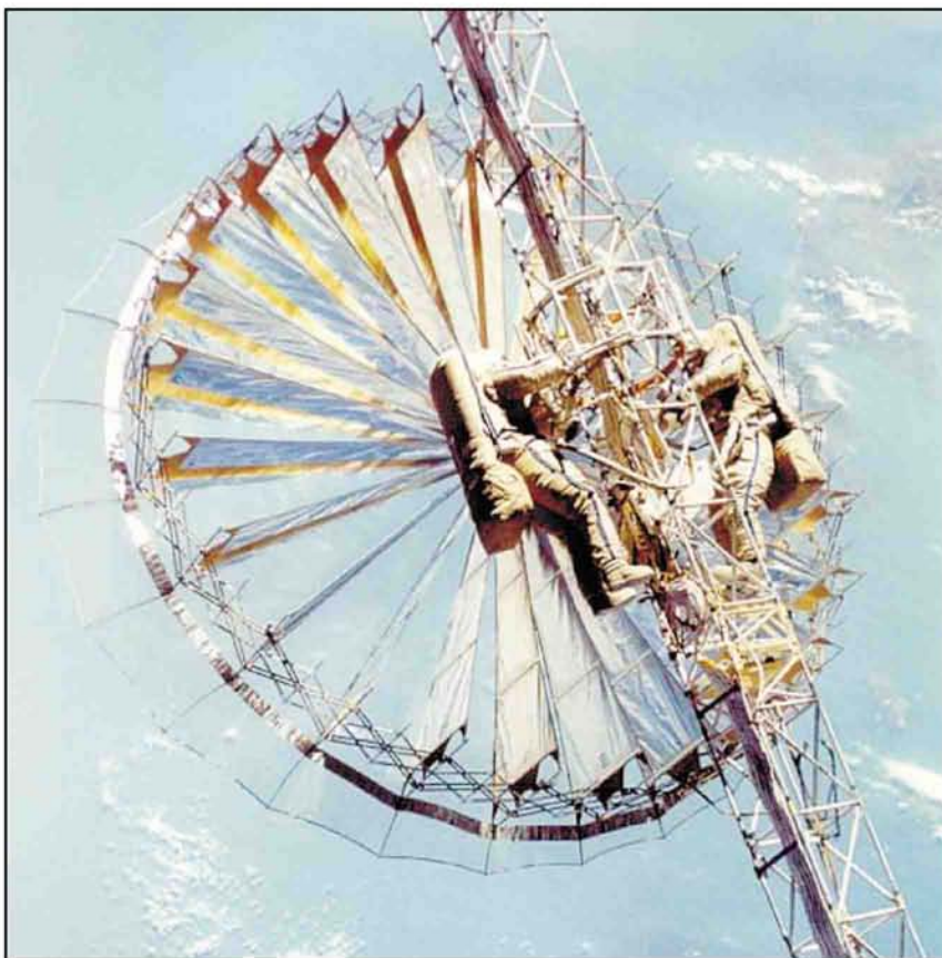
Fig. 7 - Esperimento di apertura di un riflettore "ad ombrello" a bordo della MIR
