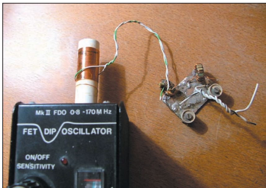
Fig. 10 - Accoppiamento fra grid-dip e toroide
