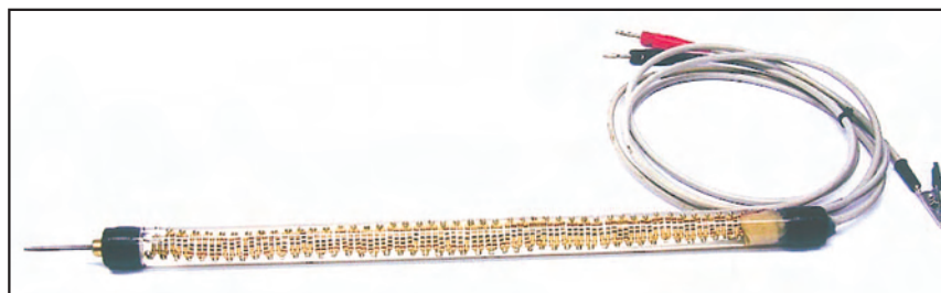
Fig. 2 a,b – Disegno descrittivo delle varie parti della sonda EAT per tester e vista della stessa finita; gli spinotti di collegamento al tester sono a banana, che è il tipo più correntemente usato negli strumenti attuali. Anche il cavetto di ritorno, provvisto di morsetto, deve essere ad alto isolamento.
