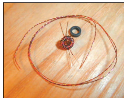
Fig. 4 - Trasformatore del "Guanella balun"
