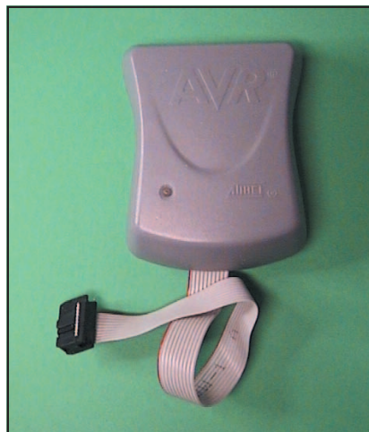
Fig. 2 - Il programmatore seriale AVRISP della Atmel (AVR InSystemProgrammer).
