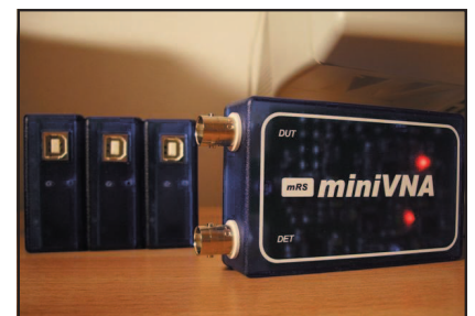
Fig. 7 - Il miniVNA nel contenitore con cui viene distribuito
