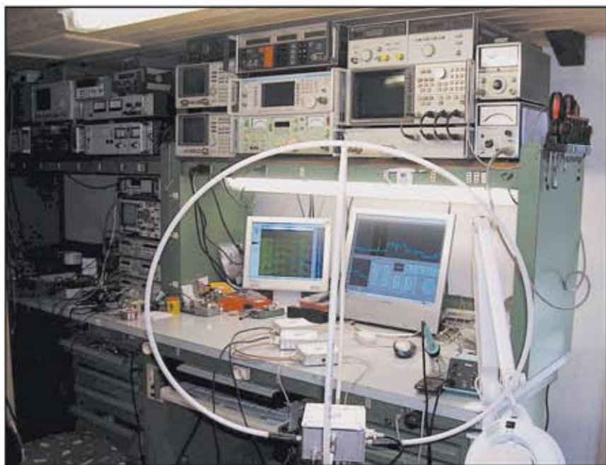
Fig. 5 - Due loop attivi L101 sfasati di 90° usati come radiogoniometro.
