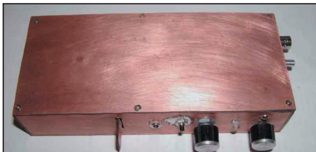
Fig. 5 - Micromountaineer in fase di montaggio, con scatola auto-costruita in vetronite
