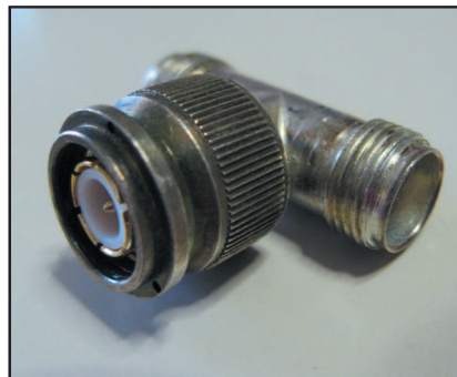
Fig. 18 - Il connettore TNC.
