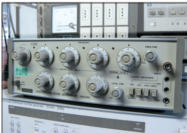
Fig. 1 - L'Anritsu MG442A nel laboratorio.
