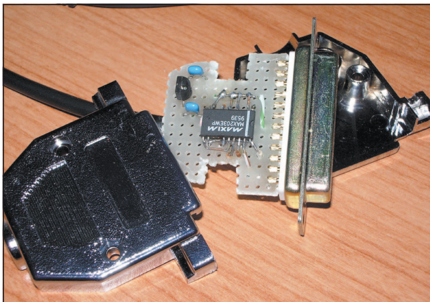
Fig. 4 - Il circuito realizzato nella vaschetta del connettore
