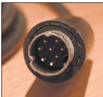
Fig. 5 - Particolare del connettore 8 pin della presa ACC
