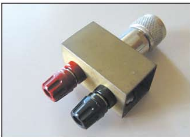
Foto 4 - Adattatore UHF-banana di costruzione casalinga.
