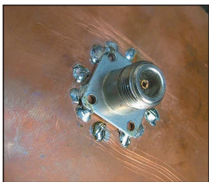
Fig. 5 - Bocchettone N sul retro del riflettore
