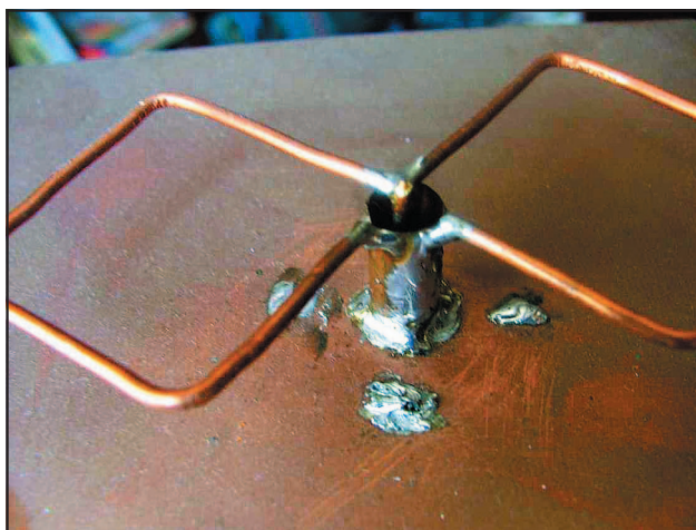
Fig. 4 - BIQUAD di IOSKK, particolari costruttivi
