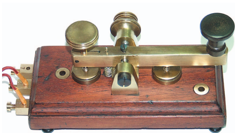
Tasto delle Poste Italiane dopo pulitura delle parti in legno e lavaggio a ultrasuoni, spazzolatura e decapaggio di quelle in metallo. I piedini di appoggio e il pomello in ebanite sono stati rifatti.
