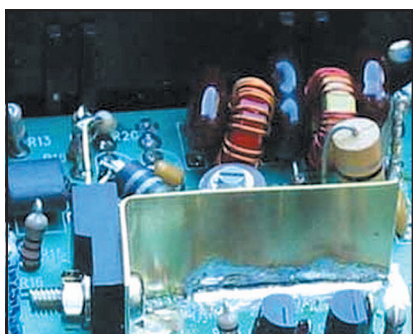
Fig. 3 - Stadio di potenza munito del dissipatore di calore.
