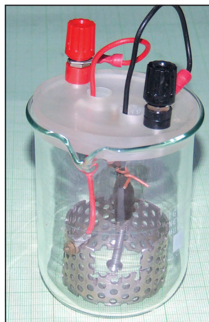
Disposizione per disossidare galvanicamente viti e piccoli particolari in acciaio.
