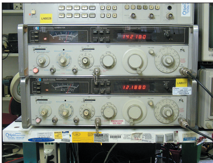
I generatori durante la misura di IMD
