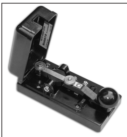
Tasto K-40 completamente in bachelite di produzione DDR. L'esemplare raffigurato si presentava già in buone condizioni, per cui è stato sufficiente un lavaggio in acqua e sapone di tutte le parti e la lucidatura di quelle in bachelite con la ruota di dischi di stoffa per cancellare piccoli graffi e opacizzazioni.
