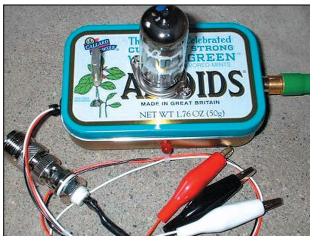
Fig. 4 - TX per 7/10 MHz di JA9MAT
