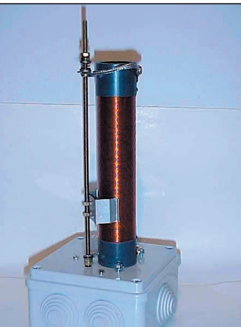
Bobina motorizzata a realizzazione ultimata
