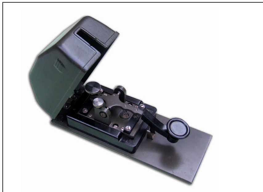
Tasto tedesco Junker in versione militare, riconoscibile come tale dalla verniciatura in verde RAL 6014. Questo esemplare non ha richiesto interventi, se non una spolveratura con aria compressa.
