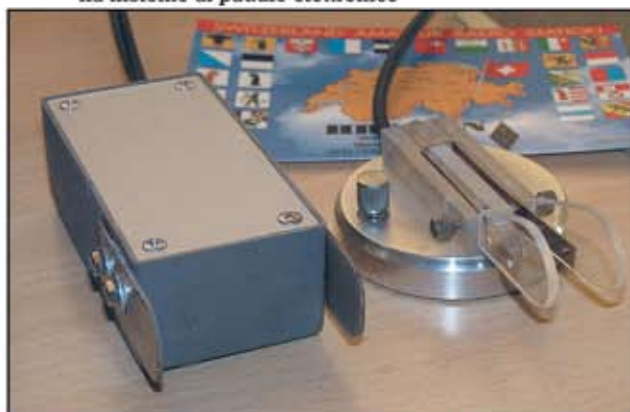
Fig. 3 - Paddle meccanico miniatura (da DX-pedition) per telegrafia insieme al paddle elettronico
