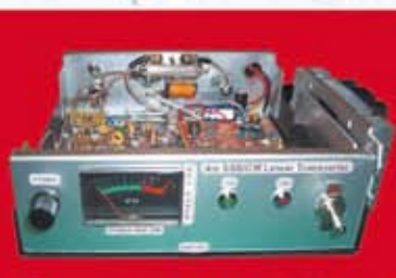
Transverter per i 4 m
