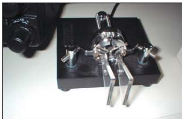
Fig. 2 - Paddle meccanico classico per telegrafia
