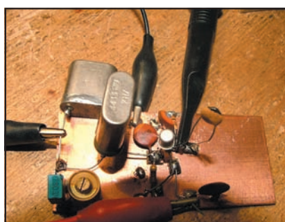
Fig. 3 - VXO-eterodina con due quarzi a 4.4 MHz per uscita a 137 kHz
