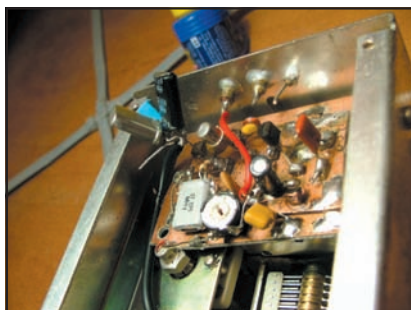
Fig. 13 – Layout del VXO da un altro punto di vista
