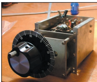
Fig. 11 – Il contenitore di un vecchio VFO Yaesu permette di sfruttare demoltiplica e condensatore variabile
