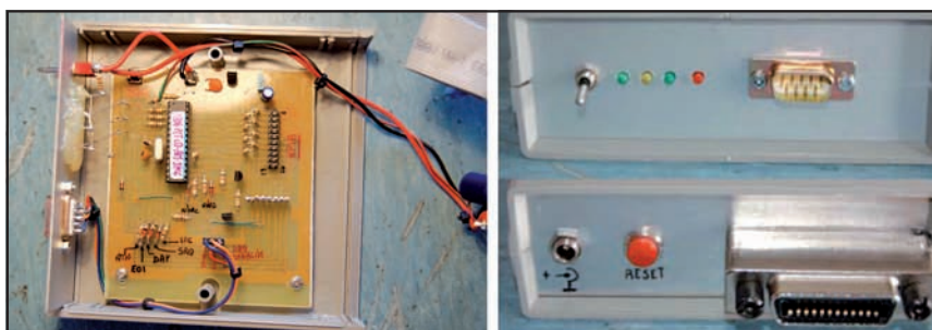
Fig. 4 - Vista interna e dei pannelli anteriore e posteriore del prototipo con uscita RS232
