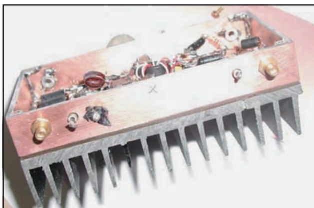
Fig. 2 - Vista di fianco con sopra i connettori SMB e condensatori passanti e sotto il dissipatore
