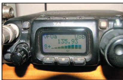
Fig. 7 – Check del segnale fatto mediante FT 817 e software Spectran
