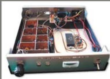
Transverter per i 6 m
