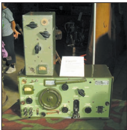
RTX Italiano da carro armato tipo Magneti Marelli TR7 RFCA
