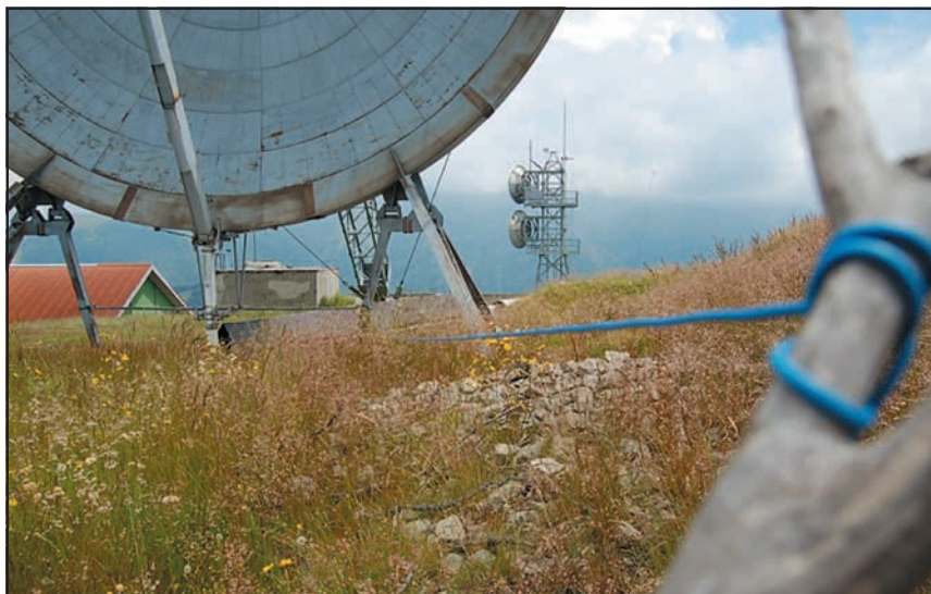
L'antenna filare connessa al ricevitore, stesa ai piedi delle parabole della stazione Monte Giogo
