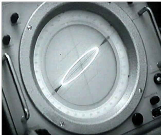
Display CRT di un radiogoniometro degli anni '60, notare l'ellisse del rilevamento.
