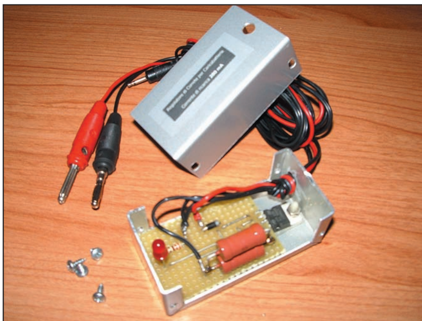
Fig. 4 - Il circuito ottenuto pronto al funzionamento. Notare che lo scatolino metallico funge anche da dissipatore per l'integrato.
