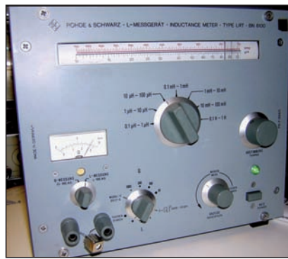
Fig. 9 - Misura dell'induttanza di bobine e trasformatori RF.
