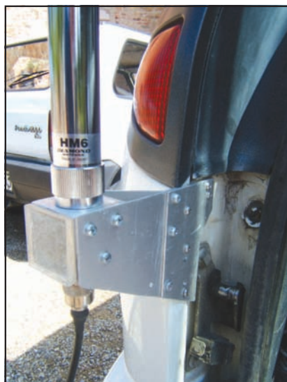
LA DIAMOND: PARTICOLARE DEL FISAGGIO ALLA CARROZZERIA Non avevo alluminio di adeguato spessore, e così mi sono arrangiato. La base dell'antenna – su profilato quadrato di alluminio 35 x 35 – è costituito da due bocchettoni PL da pannello interconnessi.
