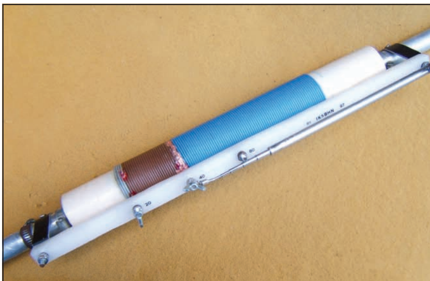
PARTICOLARE DELLA ANTENNA "T9": LA BOBINA DI CARICO
