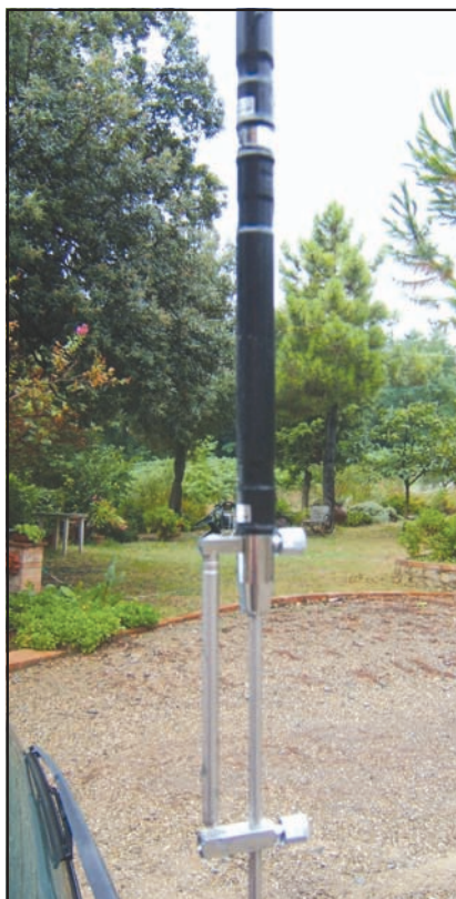
PARTICOLARE DELLA DIAMOND: IL PONTICELLO MOBILE Realizzato col sistema dell'antennina stilo, è assai pratico e veloce.
