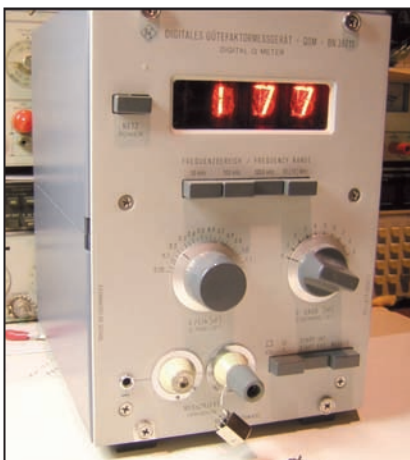
Fig. 8 - Misura del fattore di merito Q_o degli induttori.
