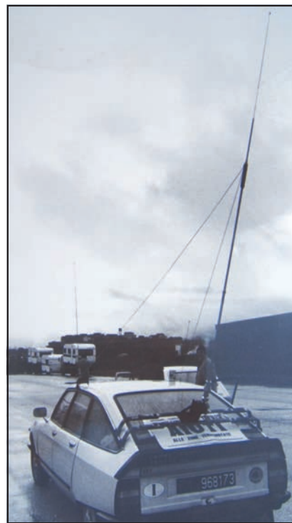
Foto 1 - TERREMOTO DI AVELLINO Montaggio della Hustler sull'auto.
