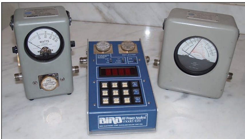
Wattmetro 4381 e wattmetri 43P e 4392
