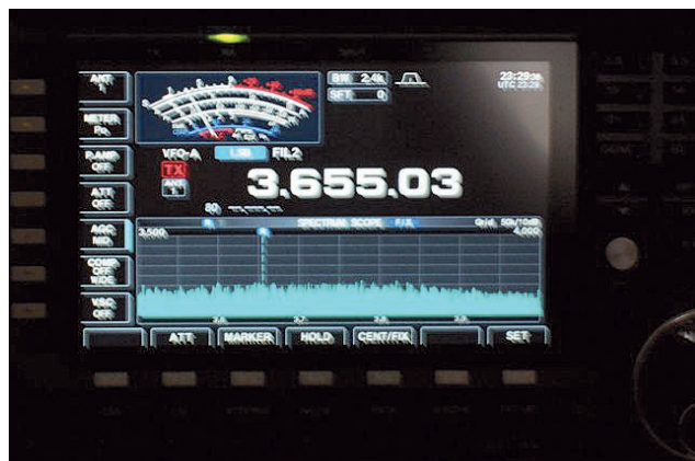
Sintonizzazione di un segnale DIGI-SEL escluso.
