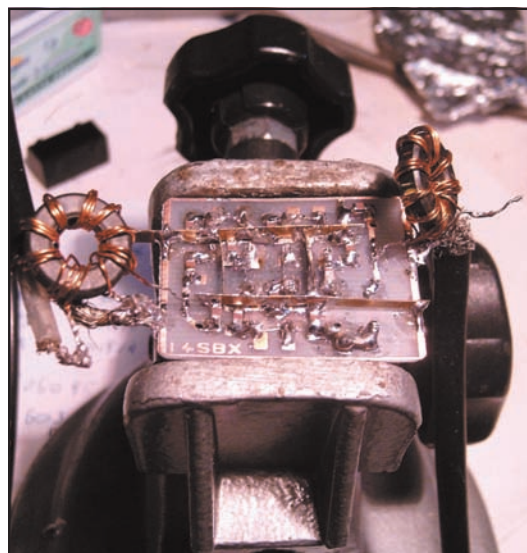
Foto 4 - Filtro ad 8 quarzi in fase di collaudo.
