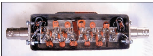
Foto 3 - Filtro con 12 quarzi TV con trasformatori di adattamento a 50 Ω.
