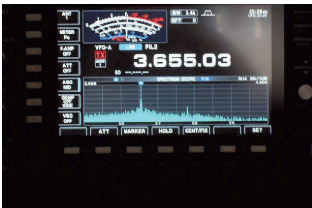
Stesso segnale ma con inserimento del DIGI-SEL.
