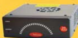
AV-825-BC Serie ultra-sottile Tensione d'ingresso: AC-220V / 240V Tensione in uscita: DC-9V / DC-16 regolabile Corrente d'uscita: 25A COMMUTATA
