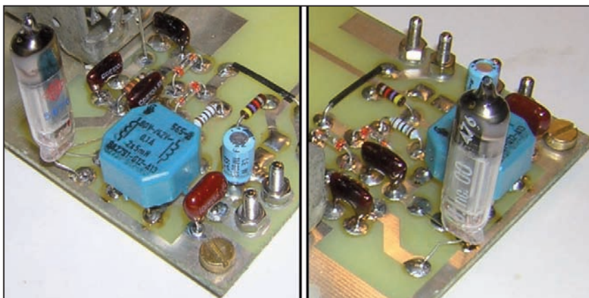
Fig. 17 - Particolari relativi al montaggio del triodo subminiatura 5676.
