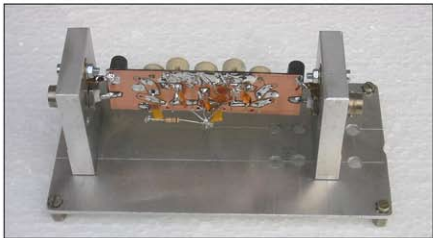
Cablaggio in aria su filtro 4 MHz
