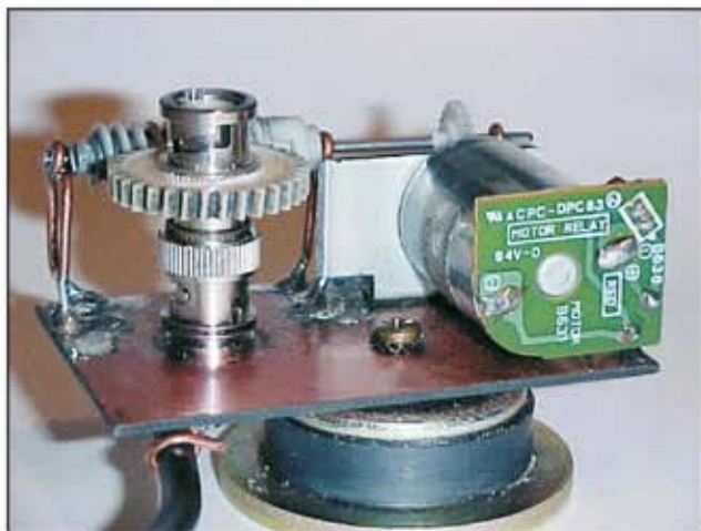
Una prospettiva del rotore d'antenna, si noti come applicare la doppia spina BNC
