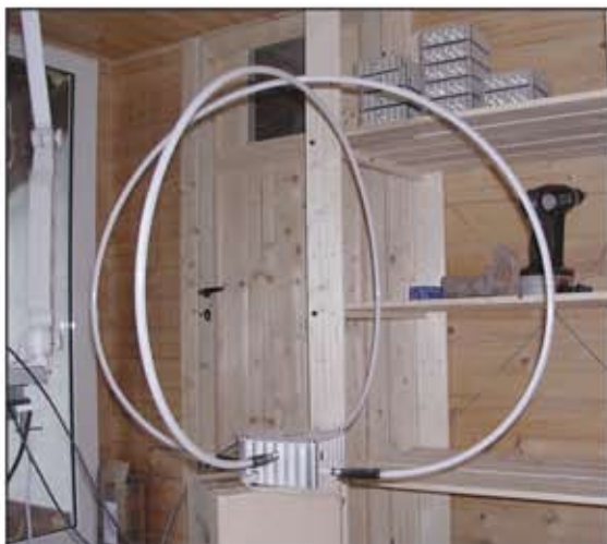
Fig. 7 - Possibile configurazione radiogoniometrica con due loop attivi L101 (100kHz-30MHz)
