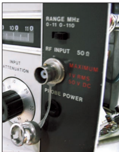
Fig. 1 - Particolare dell'ingresso RF dell'HP 8553B. Si notino i valori massimi applicabili, indicati dal costruttore.
