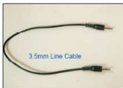
Fig. 1 - Jumper tra Line-Out e Line-In della scheda sonora
