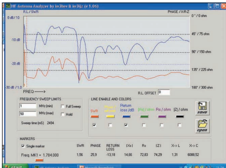
Il grafico mostra il comportamento dell'antenna presentata nell'articolo alla quale è stato applicato il balun descritto. La linea rossa indica il R.O.S. delle frequenze da 1 a 50 MHz.
