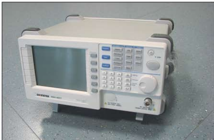
Fig. 1 - L'analizzatore di spettro GW Instek GSP-827.
