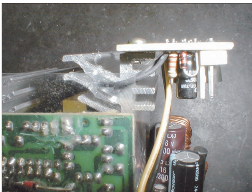
Il 250 con il regolatore di velocità della ventola
