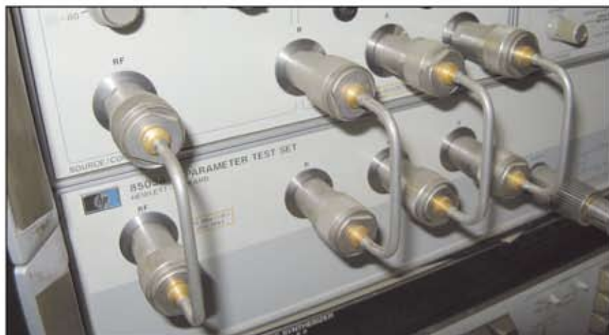
Fig. 6 - Collegamenti fra network-analyzer e unità parametri S.
