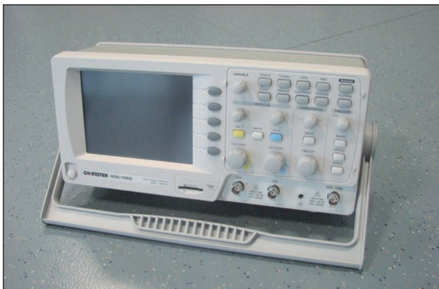
Fig. 1 - L'oscilloscopio GDS-1062 della GW-Instek.
