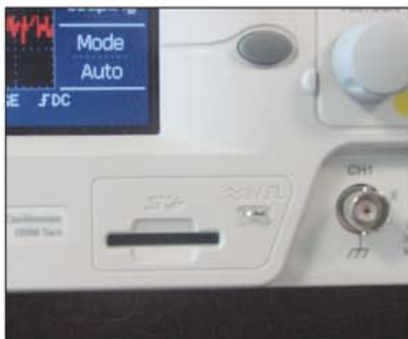
Fig. 6 - Lo slot per la SD.
