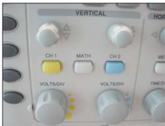
Fig. 4 - Particolare dei tasti e delle manopole del verticale.
