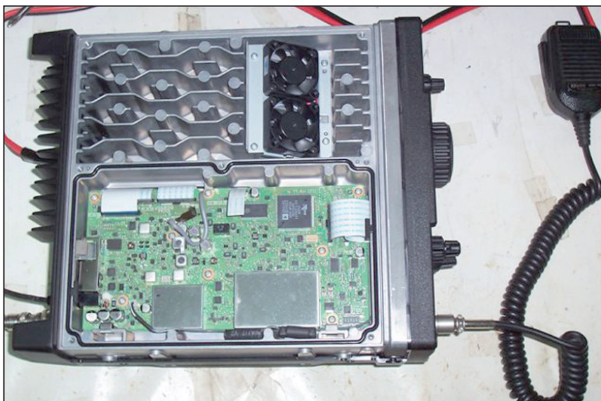
Dissipatore - ventole - RF unit/DSP
