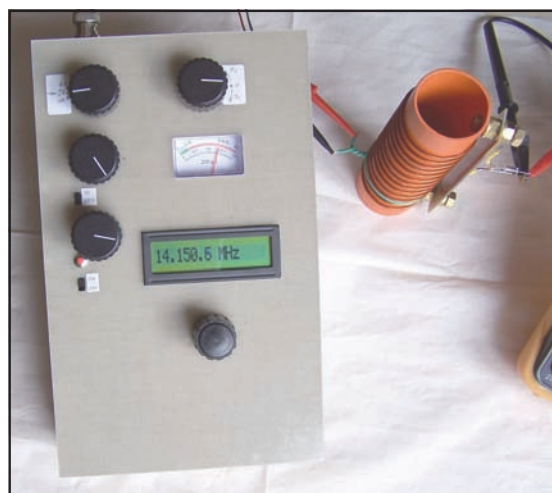
Foto 6 - Analizzatore d'antenna autocostruito. Il progetto ANTAN è stato pubblicato su RadioKit 9/2006.
