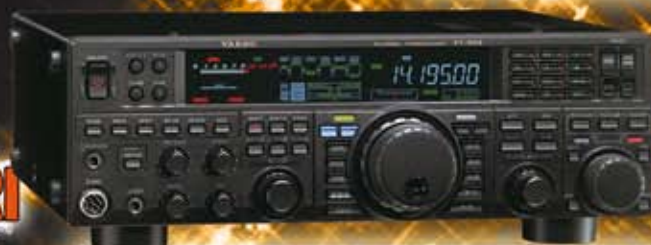
FT-950: HF/50 MHz; 100 watt - Notch digitale; DSP di nuova generazione
