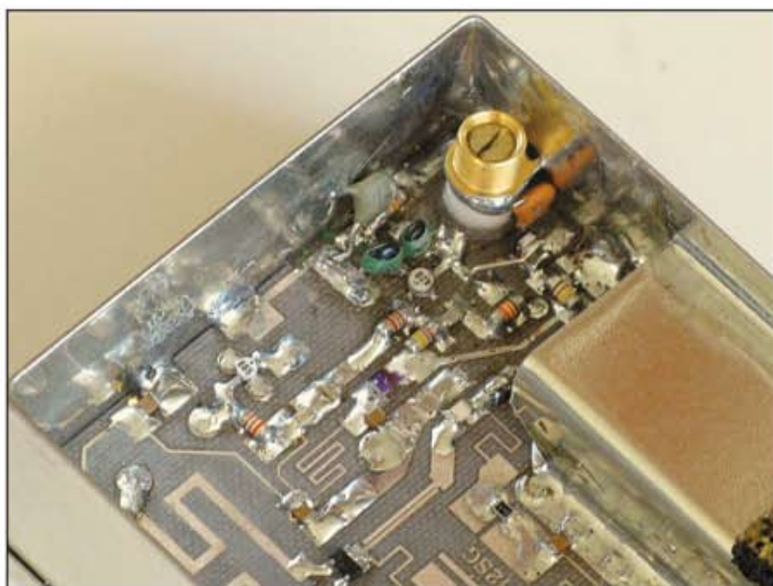
Fig. 21 - Disposizione dei componenti dell'Oscillatore Locale. Il condensatore Cv è saldato tra la parete del contenitore ed il circuito stampato.
