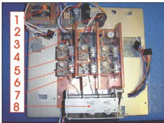
Fig. 3 - Telaio: 1 trasformatore di alimentazione; 2 trasformatore di uscita; 3 valvola finale 6AK5; 4 stadio di ingresso V2; 5 stadio mescolatore V3; 6 oscillatore locale V4; 7 schermi; 8 condensatore variabile
