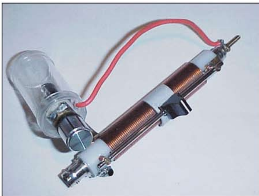
Il condensatore variabile inserito sulla bobina dell'antenna HF portatile.
