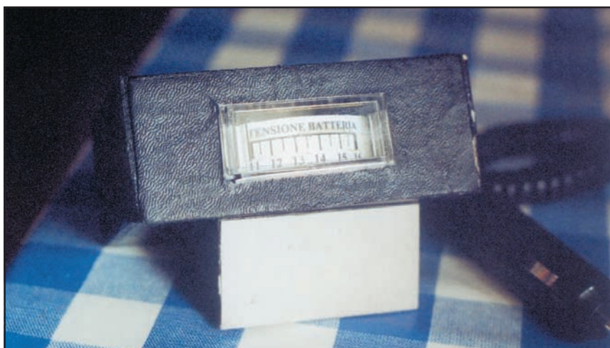
Progetto terminato. Il contenitore è stato ricoperto di simil pelle nera (bucram) e la scala dello strumento adattata all'impiego specifico.
