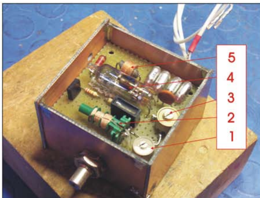
Fig. 11 - Modulo BFO: 1 condensatore variabile C1; 2 bobina L1; 3 compensatore C3; 4 valvola V9 tipo 6021; 5 impedenza di blocco RF J1
