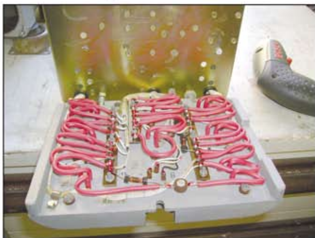
Alimentatore. Piastra porta transistor
