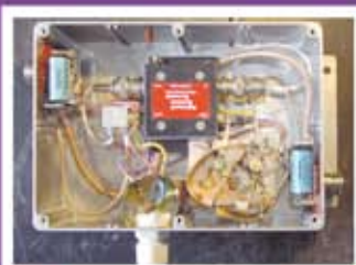
Preamplificatore per 435 MHz
