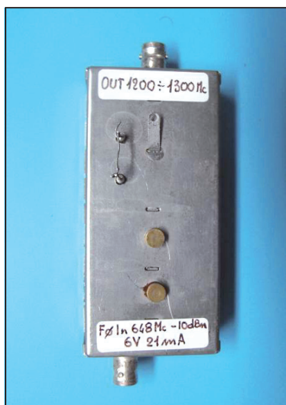
Fig. 6 - Si notino i due CV chiusi col loro tappo a vite
