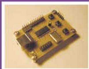
DAQ-USB con PIC18F2553
