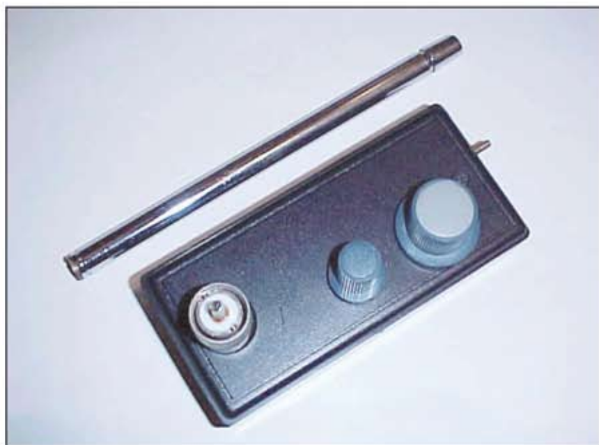
La Magic Antenna a realizzazione ultimata inserita nel suo contenitore plastico
